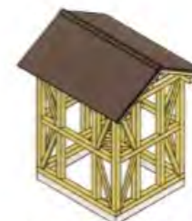
筋かい・火打の取付
