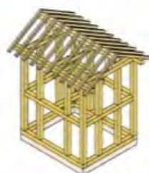
柱・梁・小屋組
